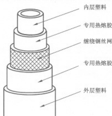
图1 管材结构图
